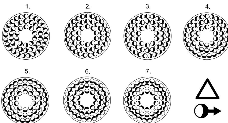
Abbildung 4. Düseneinstellung EAGLE S. BEACHTEN: Luftrichtung in der Abbildung.
