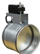
Kanalmontierte Absperrklappe Typ 4 und Klappenstellantrieb 24 V mit Federrücklauf. Die Klappe schließt bei Stromausfall oder Alarm von Frostgefahr. Der Klappenstellantrieb wird elektrisch an ein CASA-SET-Modul angeschlossen. SET-Modul und 24-V-Adapter werden bei Bedarf separat bestellt.
