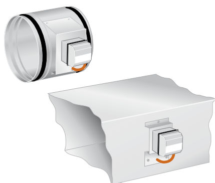
Figur 1. DETECT P för cirkulära respektive rektangulära kanaler.
