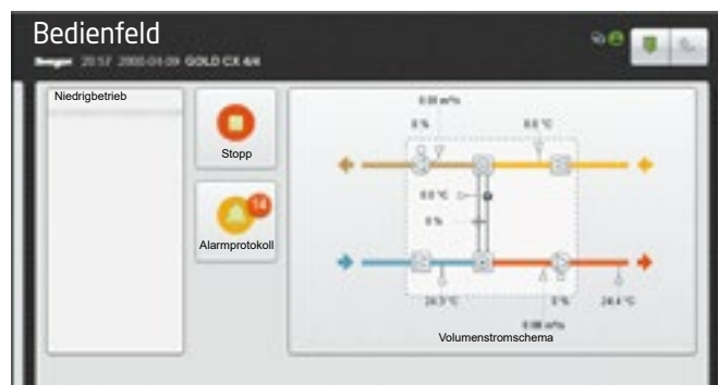
Beispiel für ein Anlagenschema im integrierten Webserver.
