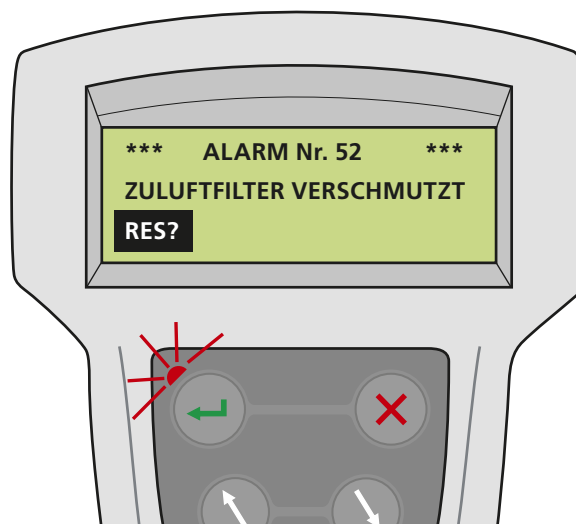
Beispiel eines Menübilds für einen Filteralarm.
